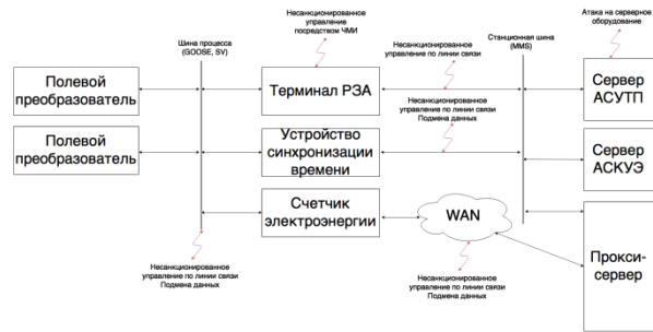
Рис 2. Архитектура подстанции нового поколения (ЦПС) с ландшафтом кибератак (вариант)
