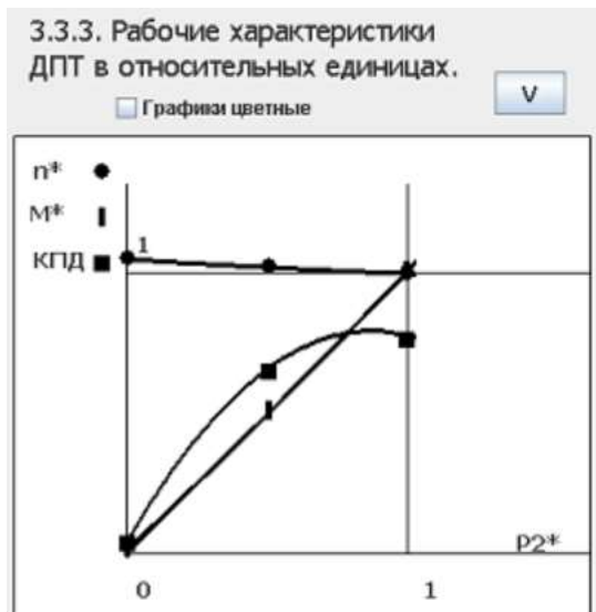
Рис. 5. Один из пунктов рабочего задания: построение рабочих характеристик ДПТ.
