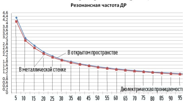
Рис. 3. Зависимость резонансной частоты ДР от диэлектрической проницаемости
