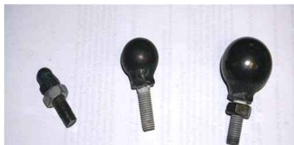
Рис. 9. Стальные инденторы используемые при ударном нагружении
