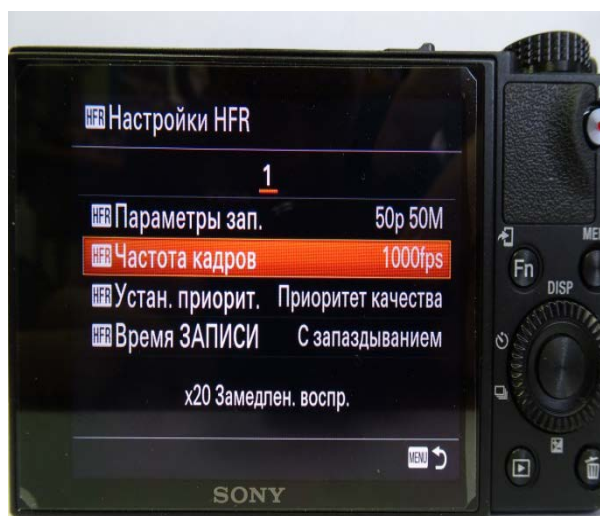
Рис. 3. Скорость видеосъемки (кадров в секунду).
