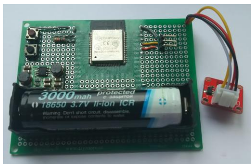
Рис. 5. Интеллектуальный беспроводной датчик для измерения параметров окружающей среды
