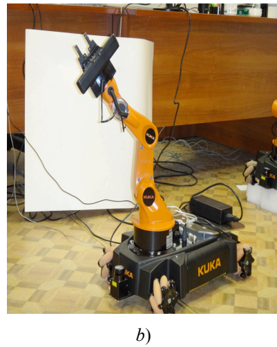
Рис. 2. KUKA youBot в положении, соответствующем решению (4): а – компьютерная модель робота, б – реальный робот
