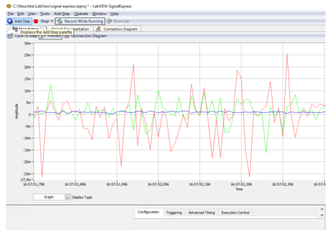
Рис. 4. Зависимость термо-ЭДС от времени в ходе эксперимента.
