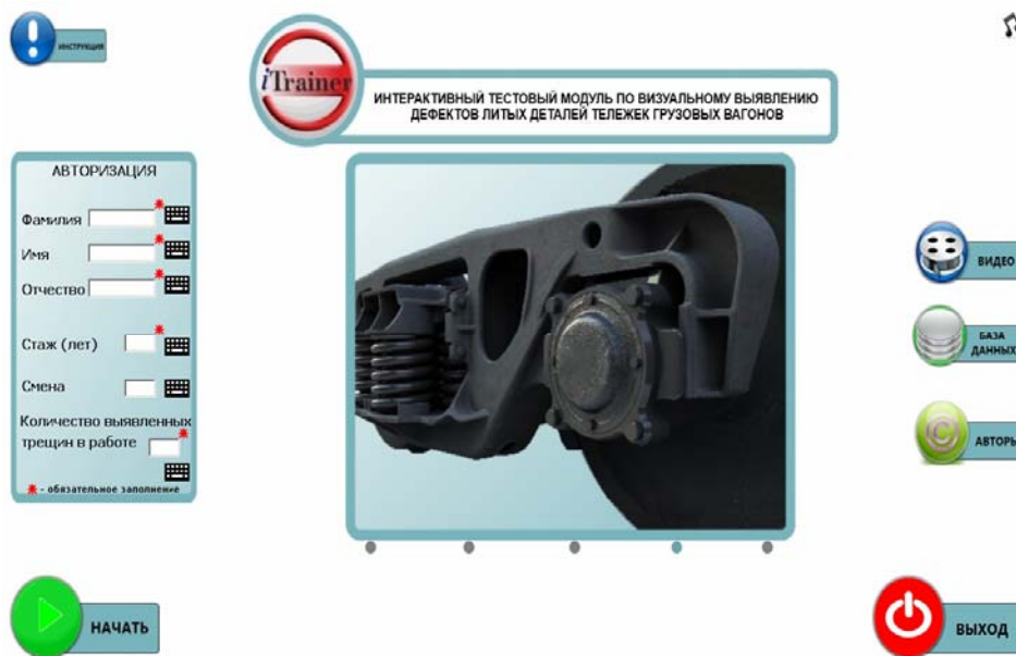
Рис. 5. Интерфейс ПО «Выявление дефектов литых деталей тележек грузовых вагонов»
