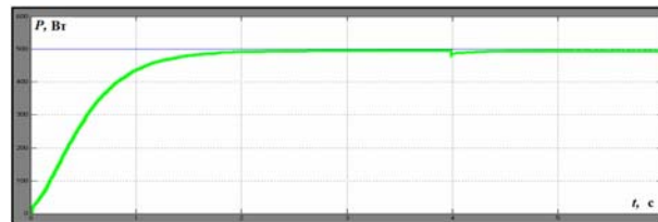
Рис. 6. Переходные процессы изменения мощности загрузки (Вт) при наличии возмущающего воздействия на 4 с
