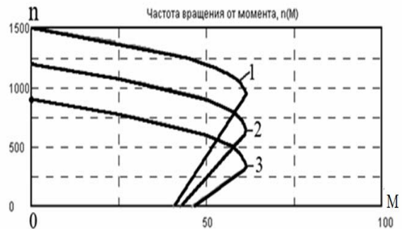
Рис. 2.1. Механические характеристики ТАД для разных значений частоты подводимого напряжения при условии U/f = \text{const} , полученные на КМ: 1 – f = f_{\text{ном}} ; 2 – f_1 < f_{\text{ном}} ; 3 – f_2 < f_1
