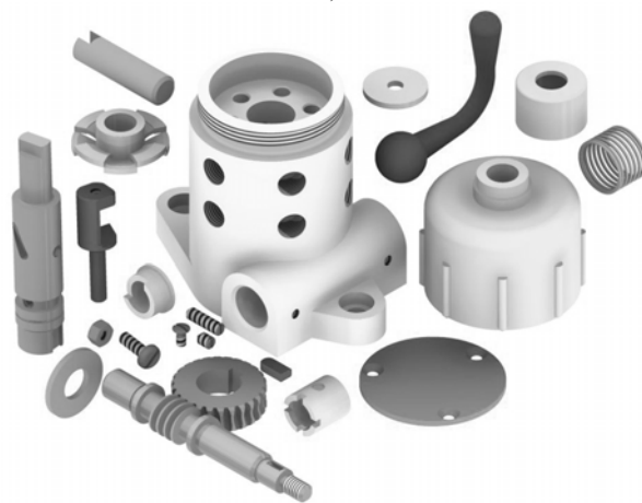
Рис. 2. 3D-модель изделия «Лубрикатор»: а — визуализация 3D модели сборки; б — детали, созданные в ходе проектирования
