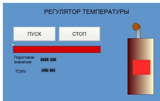
Рис. 4. Графический экран установки автоматической системы регулирования температуры
