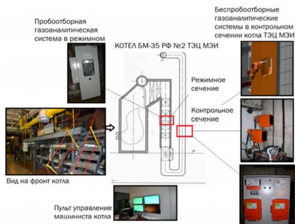
Рис. 1. Установка измерительных систем на котле
