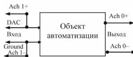
Рис. 1. Схема измерения переходных характеристик объекта автоматизации
