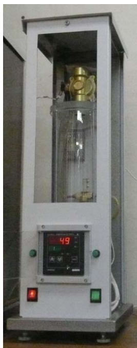
Рис. 3. Внешний вид установки «Опытное определение показателя адиабаты воздуха»
