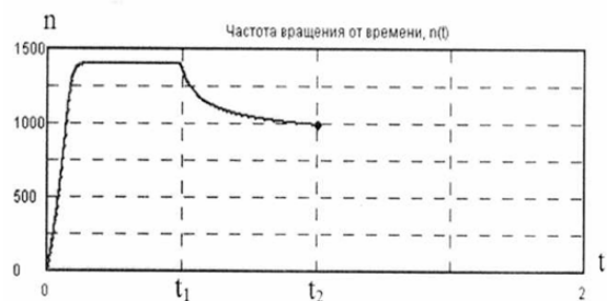
Рис. 2.4. Зависимости I(t) и n(t) , полученные при моделировании прямого пуска и регулирования частоты вращения путём изменения напряжения источника питания
