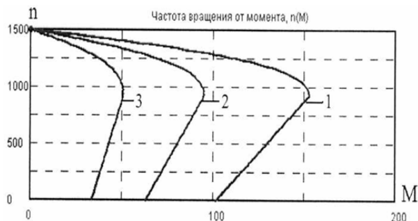
Рис. 2.3. Механические характеристики двигателя для разных значений напряжения источника питания, полученные на КМ: 1 — U = U_{ном} ; 2 — U_1 < U_{ном} ; 3 — U_2 < U_1
