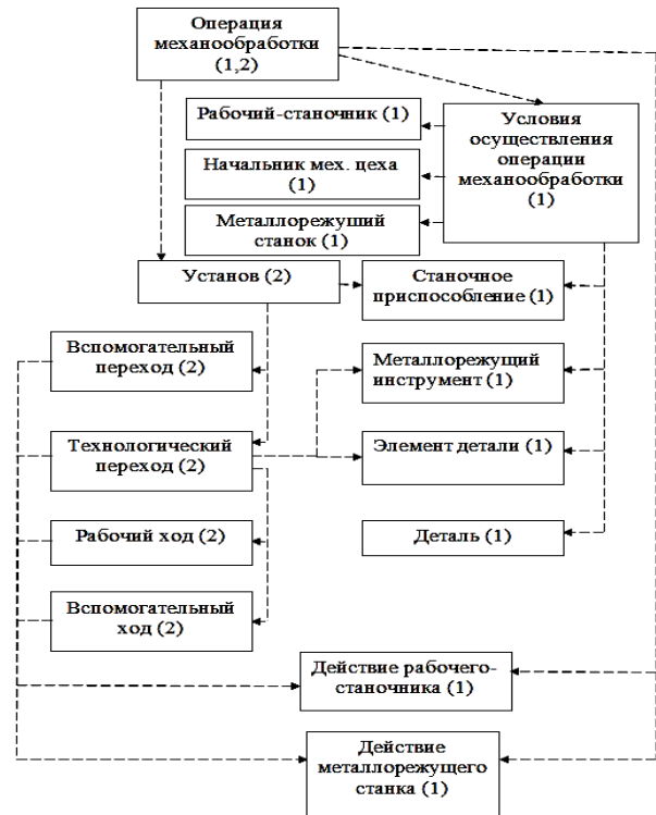
Рис. 5. Структурная схема, описывающая связь между двумя системами, обозначаемыми одним термином «операция механической обработки»
