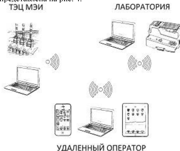
Рис. 4. Схема беспроводной «экосистемы» интегрированной лаборатории АСУ ТП
